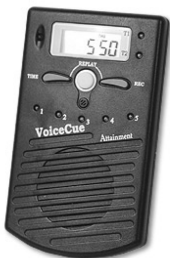
上圖，可設定 10 段時間的語音提示裝置
